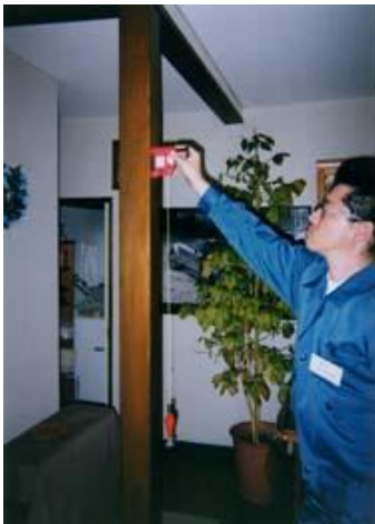
下げ振りによる傾斜の測定
